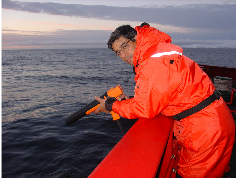
Figura 9 - Lançamento XBT para determinação da estrutura térmica da coluna d'água.
