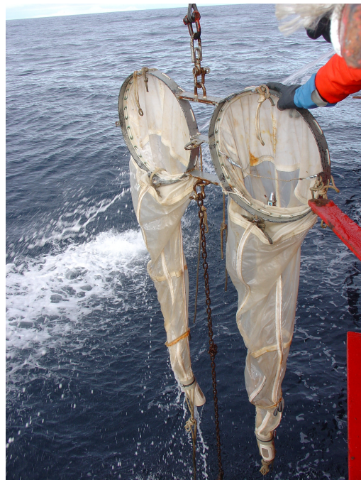
Figura 10 - Lançamento de rede bongo para coleta zooplancônica.
