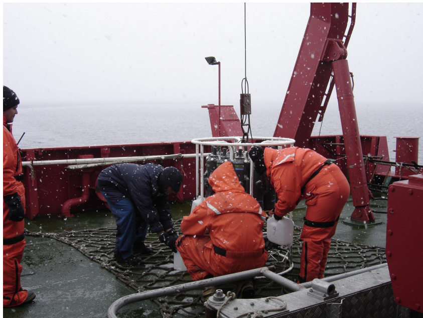
Figura 5 - Coleta de água com sistema CTD/Rosete.
