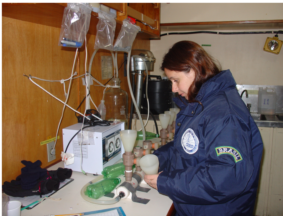
Figura 16 - Filtração da água para amostragem fitoplanctônica.
