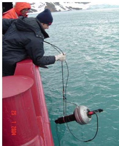
(e) Lançamento da bóia radiométrica TSRB da Satlantic Inc., Canadá.
